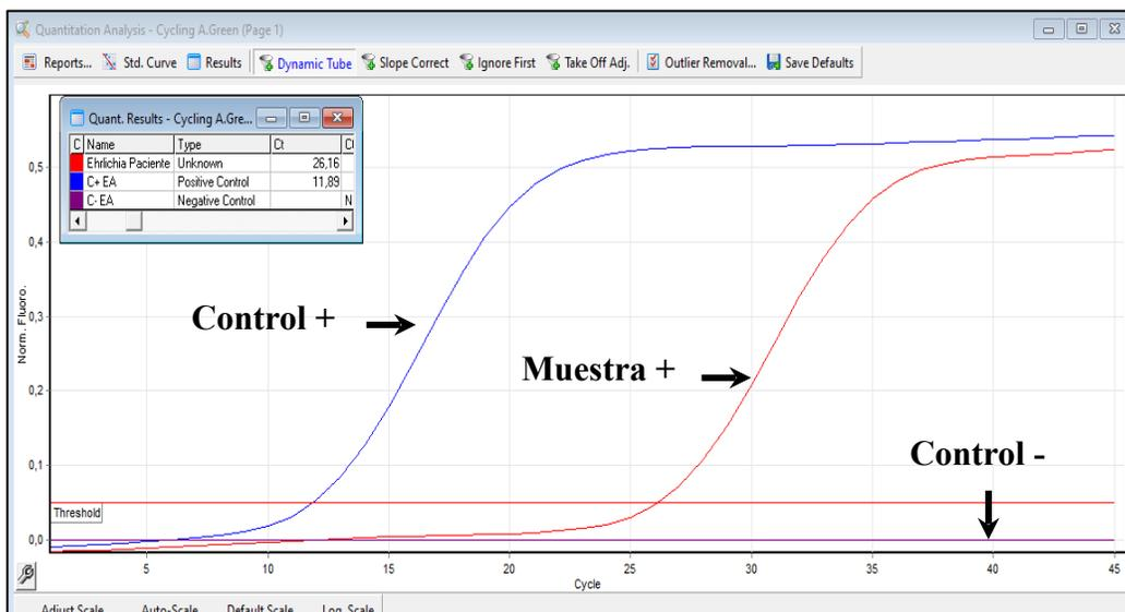
**Imagen 1.** Curvas de amplificación esperadas canal green (FAM).
